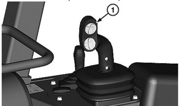
Palanca de control de la hoja—Máquinas con control de pendiente integrado (IGC)
