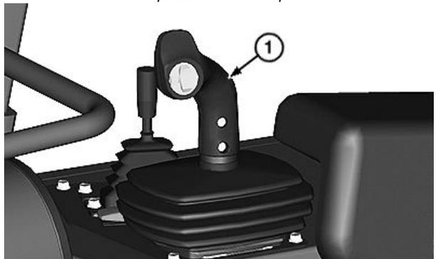
Palanca de control de la hoja—Rotación asistida (PAT), máquinas con control piloto
