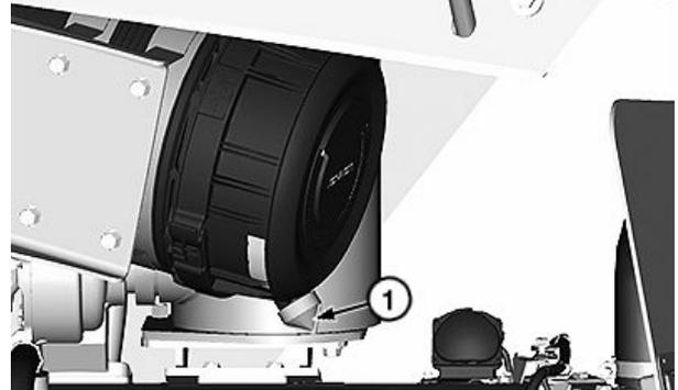
Válvula de descarga de polvo del filtro de aire—Motor 6090HT001
