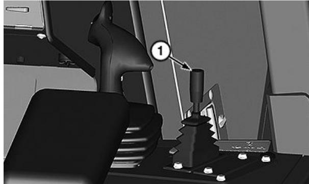
Palanca de control auxiliar—Máquinas sin control de pendiente integrado (IGC)
