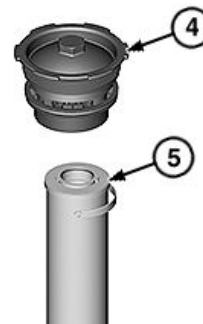
Cubierta y cartucho filtrante de retorno del sistema hidráulico
