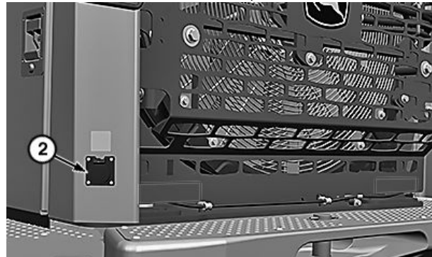
Conexión de alimentación eléctrica
