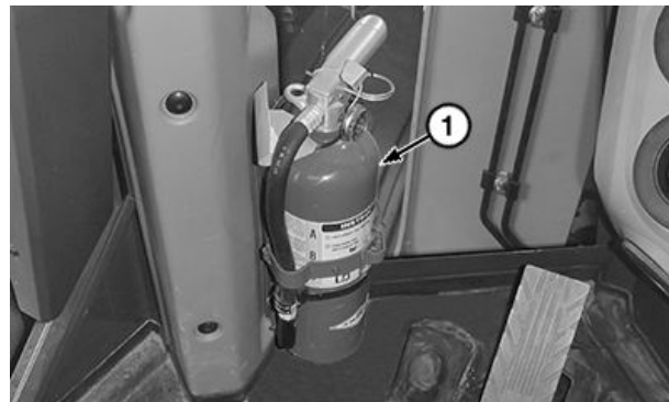
Ubicación de montaje del extintor de incendios
