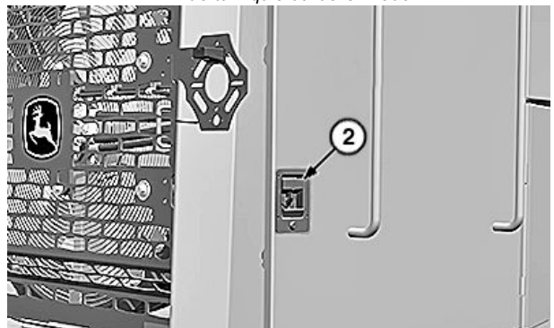
Puerta derecha de enfriador
