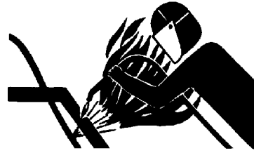
Calentamiento cerca de tuberías a presión
