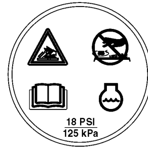
ADVERTENCIA: sistema presurizado
