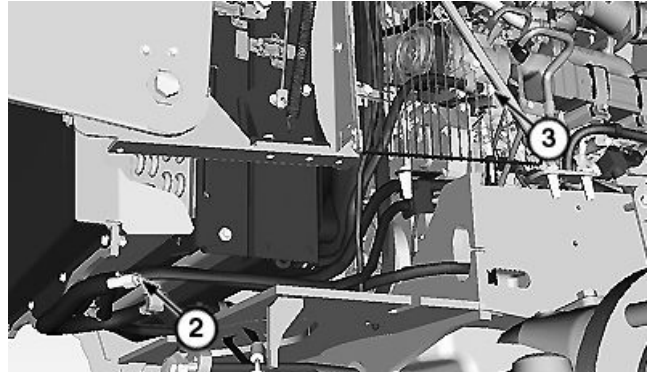
Mangueras de vaciado del sistema de refrigeración (se muestra motor 4045TT096)
