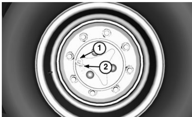
Tapón de llenado de la carcasa de planetarios de la tracción delantera (TDM)
