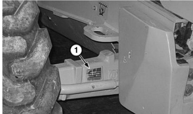
Ubicación de la chapa de identificación de la carcasa del eje delantero de TDM
