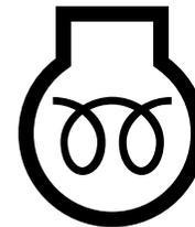
Indicador del calefactor del motor
