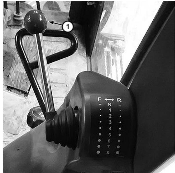
Palanca de control de la transmisión
